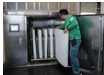
四重システム：温水洗浄＋加熱蒸気＋抗菌処理＋高温加熱処理
