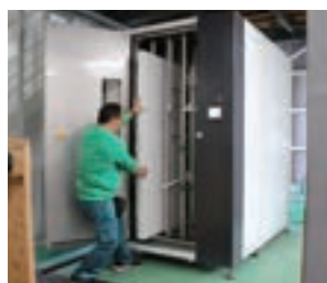
四重システム：温水洗浄＋加熱蒸気＋抗菌処理＋高温加熱処理
